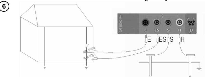
Conectar el electrodo de corriente clavado en la tierra con la toma **H** del medidor,
