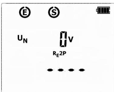
En las funciones  $R_{E2P}$ ,  $R_{E3P}$ ,  $R_{E4P}$ ,  $R_{E3P+C}$ ,  $R_{CONT}$ ,  $\rho$  antes de pulsar el botón "START" el medidor controla la tensión en los bornes de medición (entre la toma E y otras tomas) y el valor de la tensión de interferencia se visualiza en la pantalla.
