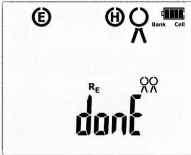
Aparece el mensaje **done** que indica la finalización del proceso de calibración de la pinza de medición.
