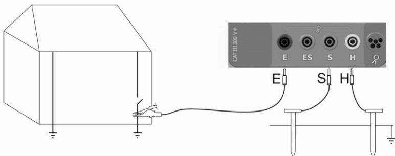
Conectar el electrodo de corriente clavado en la tierra con la toma **H** del medidor, Conectar el electrodo de tensión clavado en la tierra con la toma **S** del medidor, Conectar la toma de tierra estudiada con la toma **E** del medidor, La toma a tierra examinada y el electrodo de corriente y tensión se deben colocar en una línea.
